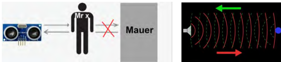
Abb. 22 Der Ultraschallsensor erkennt eine Person, wenn die ausgesandten Wellen schneller zurückkehren, als wenn sie die Distanz bis zur Mauer bewältigen müssen.
