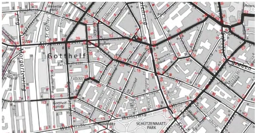
Abb. 121 Ausschnitt aus dem Plan mit dem gesamten Fussverkehrsaufkommen (rote Zahlen = Anzahl Etappen je Strassenabschnitt) Quelle: Pestalozzi & Stäheli, 2013, S. 7
