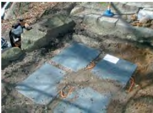
Abb. 20 Hintereinanderliegende Sensoren ermöglichen die Erfassung der Gehrichtung.
